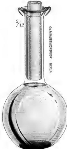
Fig. 21. Anaerobenzüchtung in Glaskolben nach O. Lentz.
